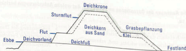
Abbildung 8: Querschnitt eines Deiches (eigene Darstellung)
